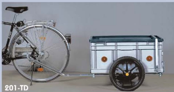
Zuladung 50 kg. Als Handwagen 100 kg. Leergewicht 11 kg ohne Box.
